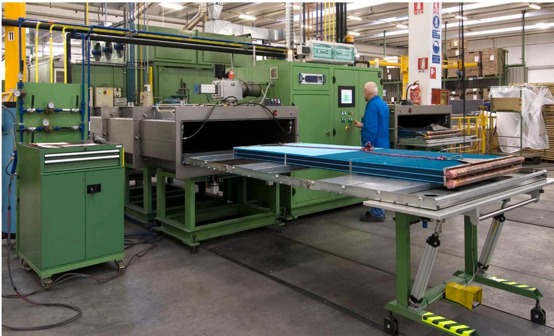
Camera a elio per test di tenuta
